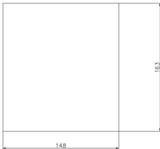
图 8-2 安装开孔尺寸
